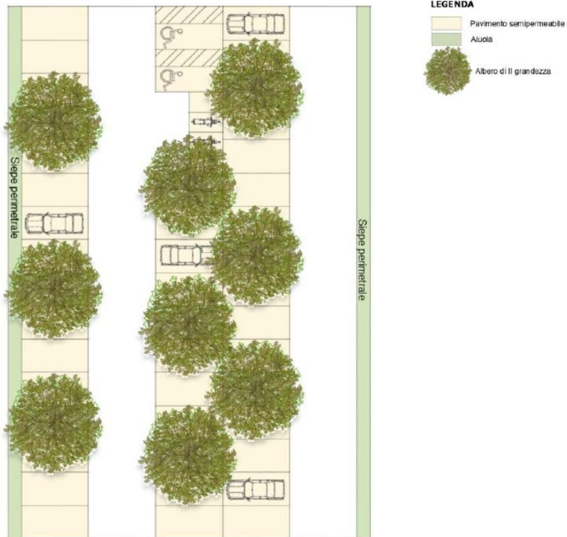
**Figura 4-14 Esempio di parcheggio a spina di pesce con stalli semipermeabili**
